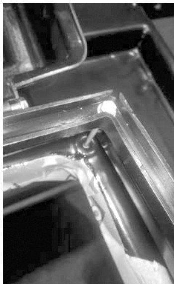
f. Připevnění poklopu k základně.
