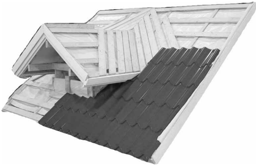
25a. Položte střešní tabuli od okapu směrem k hřebeni střechy tak, aby přesahovala konec úžlabí o min. 400 mm
